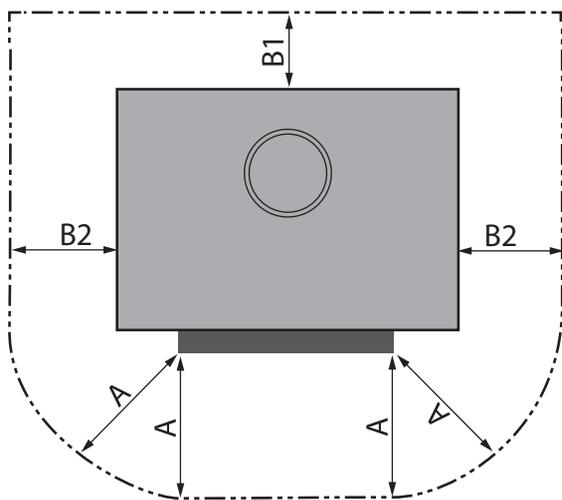
Distances de sécurité minimales à respecter par rapport à tout matériau de construction inflammable :
