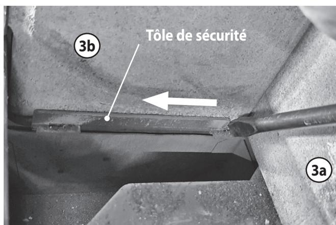
Dans la partie supérieure de la chambre de combustion se trouvent 3 **défecteurs**. Deux **défecteurs en vermiculite** sont installés sur le **défecteur** situé à **l'avant**. Ceux-ci peuvent être retirés sans problème en même temps que le **défecteur avant**.
