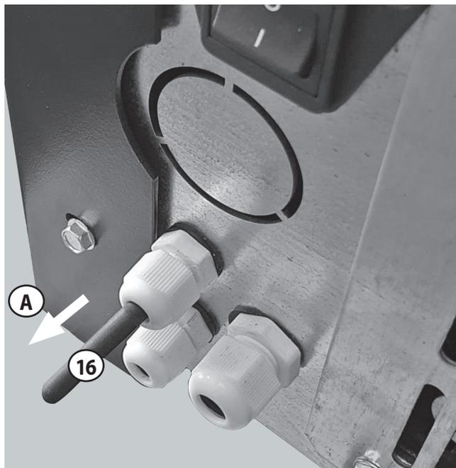
Dans certains cas, il peut s'avérer nécessaire de sortir la **sonde de température ambiante (16)** encore davantage de l'appareil **(B)**.
