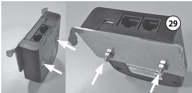
Connectez le **module Wi-Fi (29)** à l'appareil. Le câble de connexion se trouve dans un passage de câbles sur l'arrière de l'appareil, près du **branchement au secteur (20)**.
