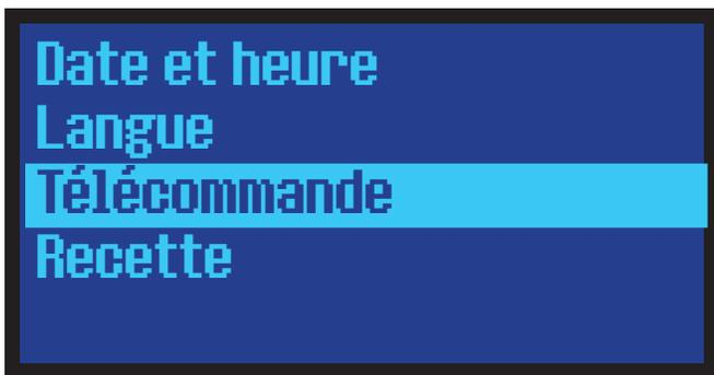
L'appareil peut être commandé à distance à l'aide de la télécommande (disponible en option) (→ chapitre 8.9). Le récepteur est déjà intégré à l'appareil et peut être activé ou désactivé dans le menu principal.
